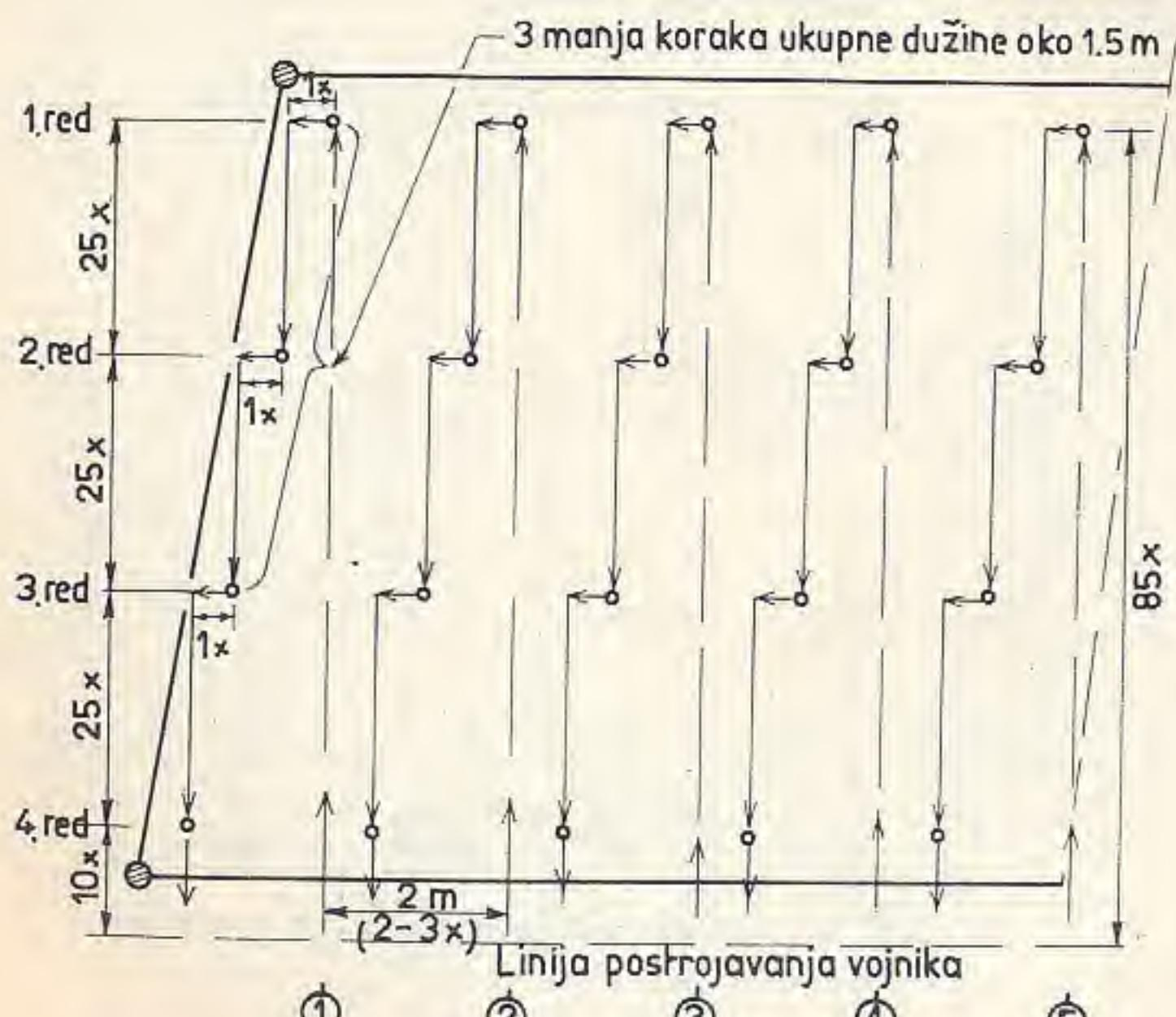
Sl. 26 — Način raspoređivanja protivpešadijskih mina stro-
